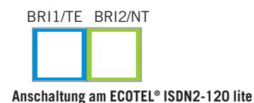
**ECOTEL® am externen SO-Anschluss des TK-Systems:** Alle Extern-Gespräche aus dem TK-System, die ins ISDN-Festnetz gehen, werden vom TK-System über das externe SO-1 Port zum NTBA geroutet. Alle Gespräche aus dem TK-System, die ins GSM-Netz gehen, werden vom TK-System über das externe SO-2 Port zum ECOTEL® geroutet.
